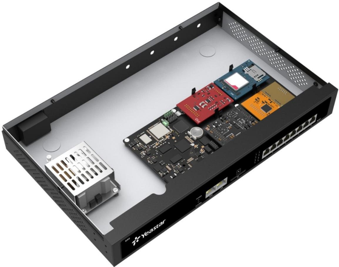
**Ústředna obsahuje 4 pozice pro moduly:** S2 (2x analogový telefon), O2 (2x analogová linka), BRI (2x ISDN2), SO modul (1x an. telefon, 1x an. linka), GSM (1x GSM kanál, modul verze SIM800) a LTE (1x 3G/4G kanál)
